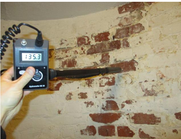
Kuvat 44-45, pohjakerroksen seinä- ja lattiapinnat kosteat
