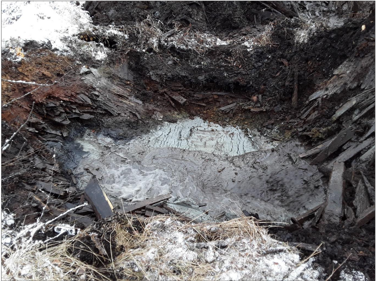
Kuva 7. Koekuoppa KK19B koostui lähes pelkästään lankkua ja rimaa ja sahanpurua sisältävästä kerroksesta, jossa kulki runsaasti vettä. Pohjalla näkyy savinen perusmaa.
