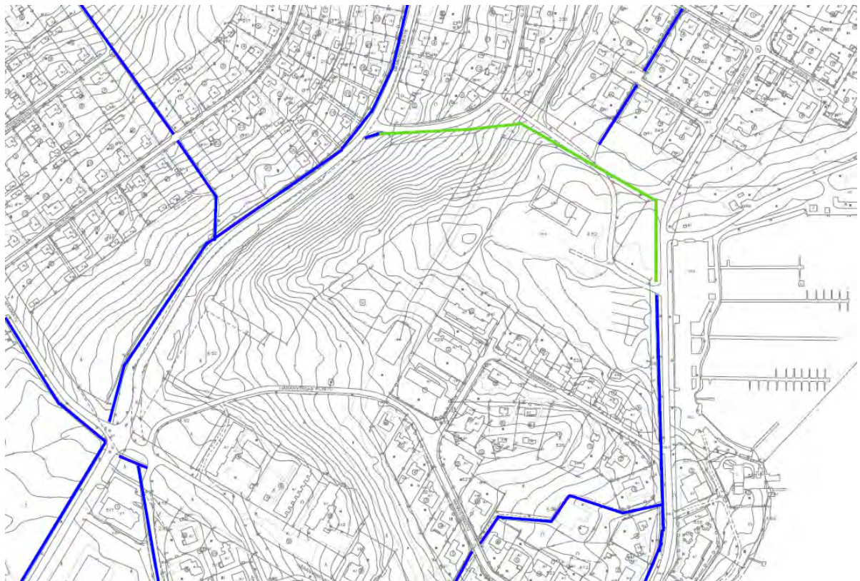
Kuva. Kevyen liikenteen väyliä suunnittelualueen ympäristössä. Sinisellä on esitetty olemassa olevat väylät ja vihreällä kaavaratkaisun toteuttamisen mukaiset uudet yhteydet. Uusien yhteyksien sijainnit viitteellisiä ja tarkentuvat katusuunnittelun yhteydessä.
