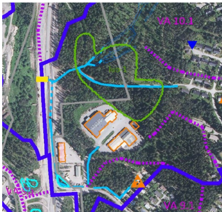
Kuva 18. Kuva hulevesisuunnitelman nykytilakartasta. Suunnittelualueella teollisuusrakennukset on esitetty hulevedelle laadullisena riskitekijänä (oranssit ääriviivat). Vihreä luo-1 aluerajaus osoittaa luontodirektiivin asuinalueen.
